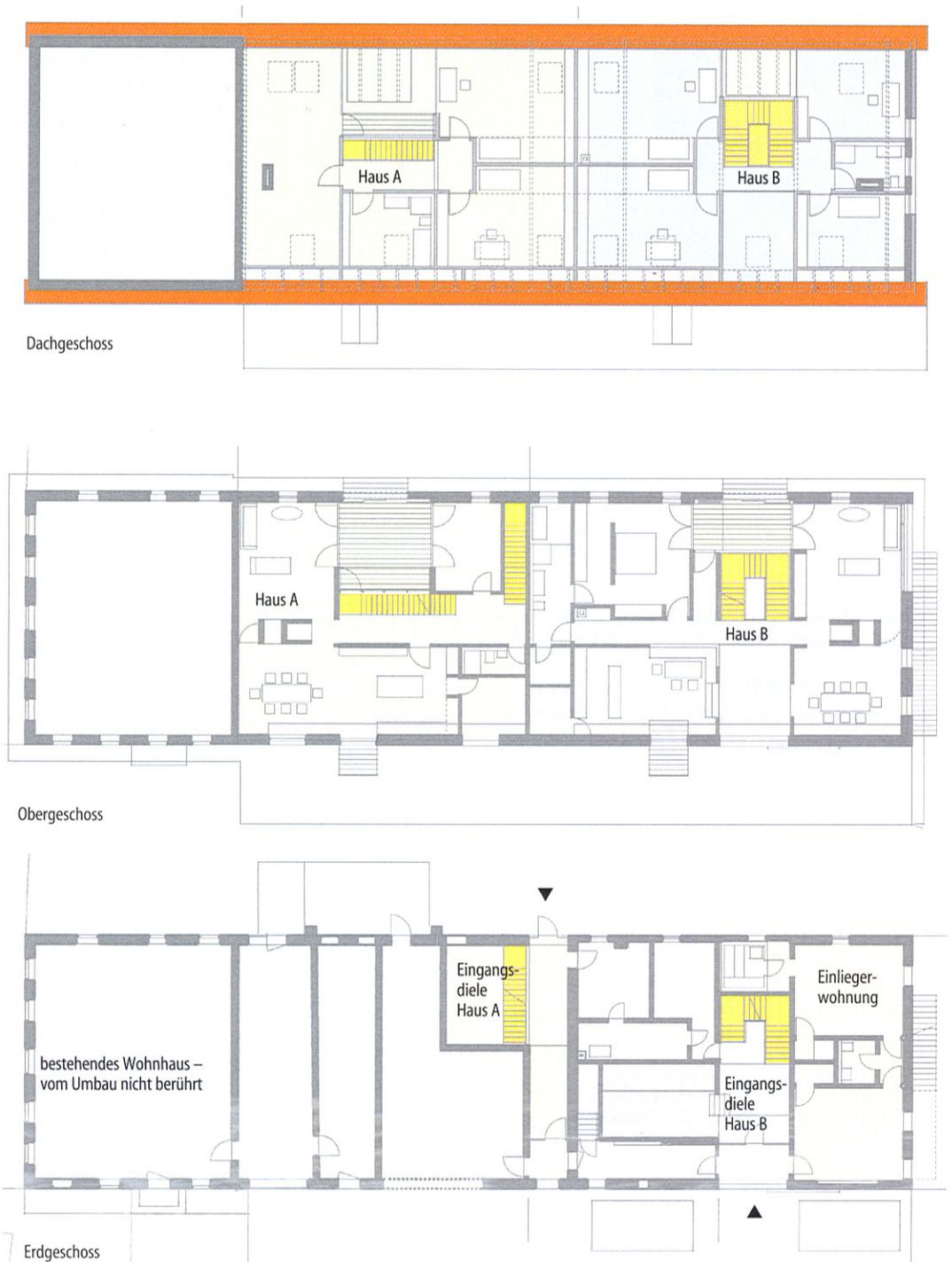
**Abb. B.1.6:** Grundrisse der umgebauten Scheune (M 1:300). Die als eigenständige Häuser errichteten Einheiten sind bau- und eigentumsrechtlich Wohnungen.
